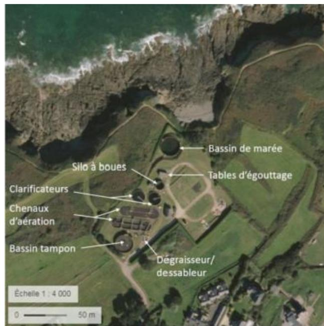
« Le volume de stockage des boues nécessaire permet d'envisager la reconversion de l'actuel bassin à marée d'une capacité de 1 500 m<sup>3</sup> en stockage des boues, ce qui, combiné au silo existant de 400 m<sup>3</sup>, permettrait de disposer d'un volume total de stockage de 1 900 m<sup>3</sup>. Cette solution serait envisageable sous réserve de la suppression du phasage du rejet actuel.
